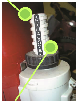
Instelling van de letter (geen verticale schroef)
