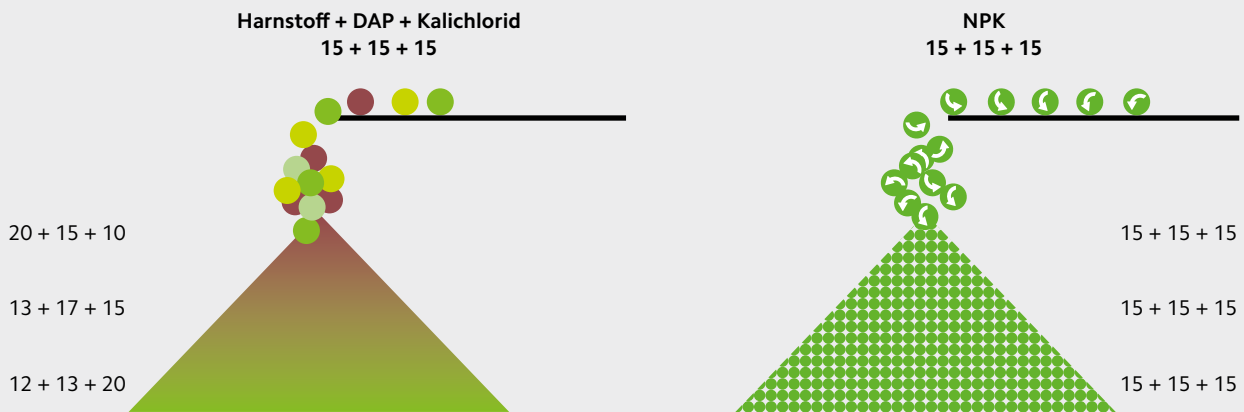
Abb. 13: Entmischung von Mischdüngern am Beispiel eines NPK mit der Formel 15-15-15 aufgrund von unterschiedlichem, spezifischem Gewicht und Größe der Blendkomponenten
