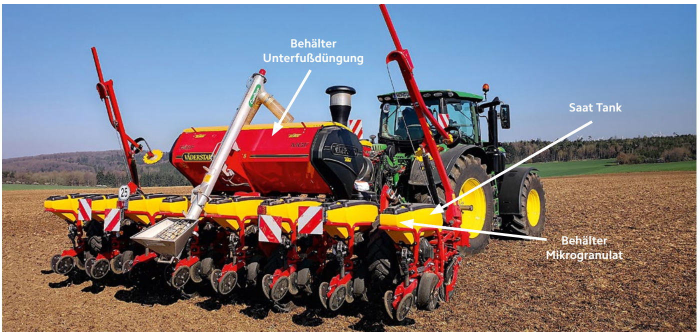
Väderstad Tempo F Einzelkornsämaschine mit Mikrogranulatstreuer
