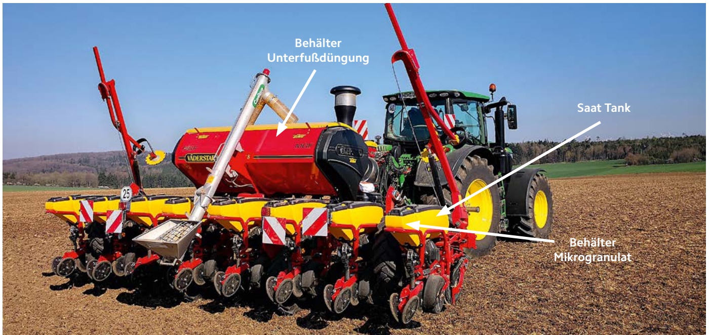
Väderstadt Tempo F Einzelkornsämaschine mit Mikrogranulatstreuer
